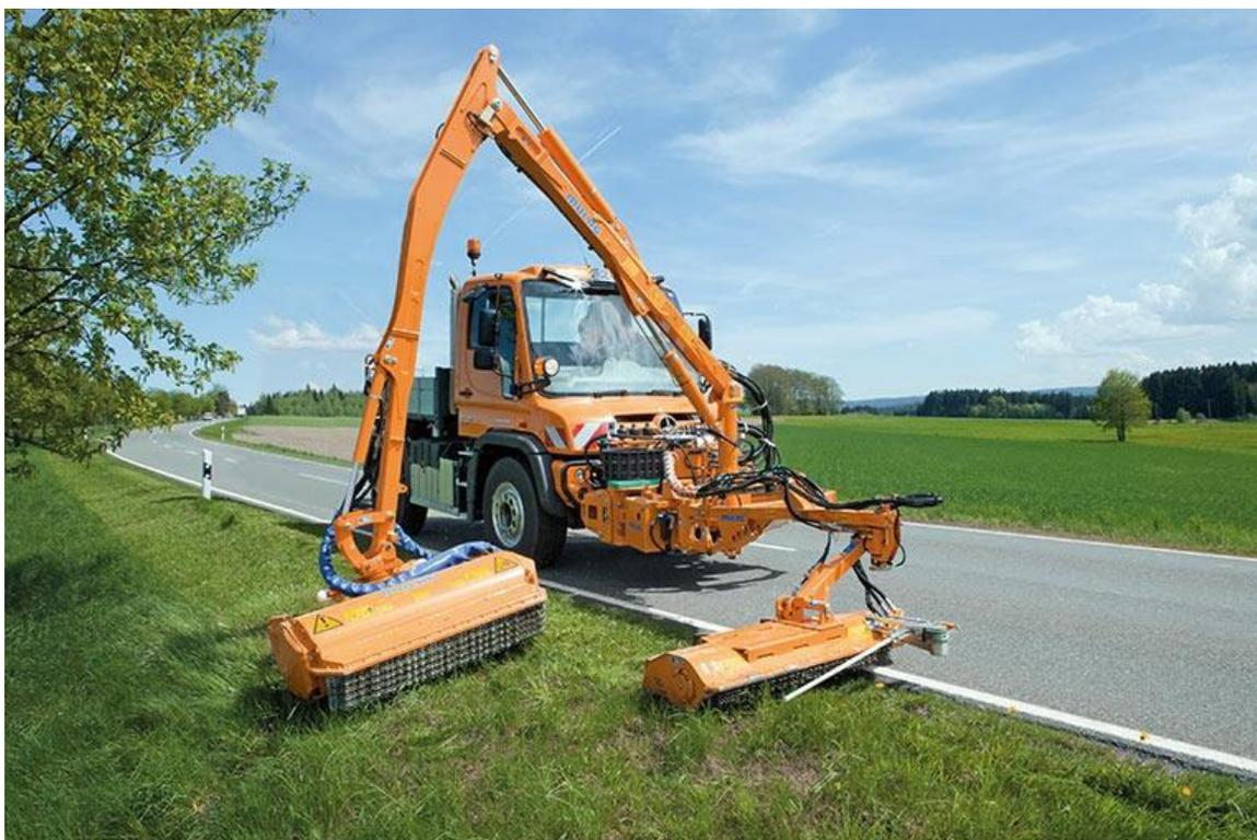
Abbildung 18: Schnitt des Intensivbereichs mit einer Mulchmaschine (Hell Landmaschinen, 2017).
