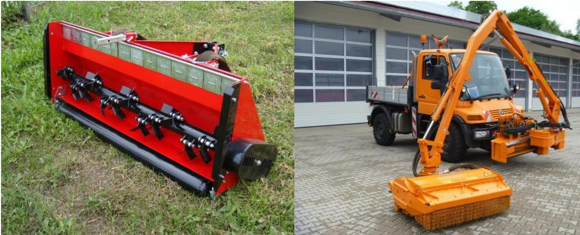
Abbildung 10: Links: Schlegelmähwerk eines Schlegelmulchers (Proplanta, o. J.); Rechts: Schlegelmulchgerät mit Auslegerarm (Unimog Huber GbR, 2017).
