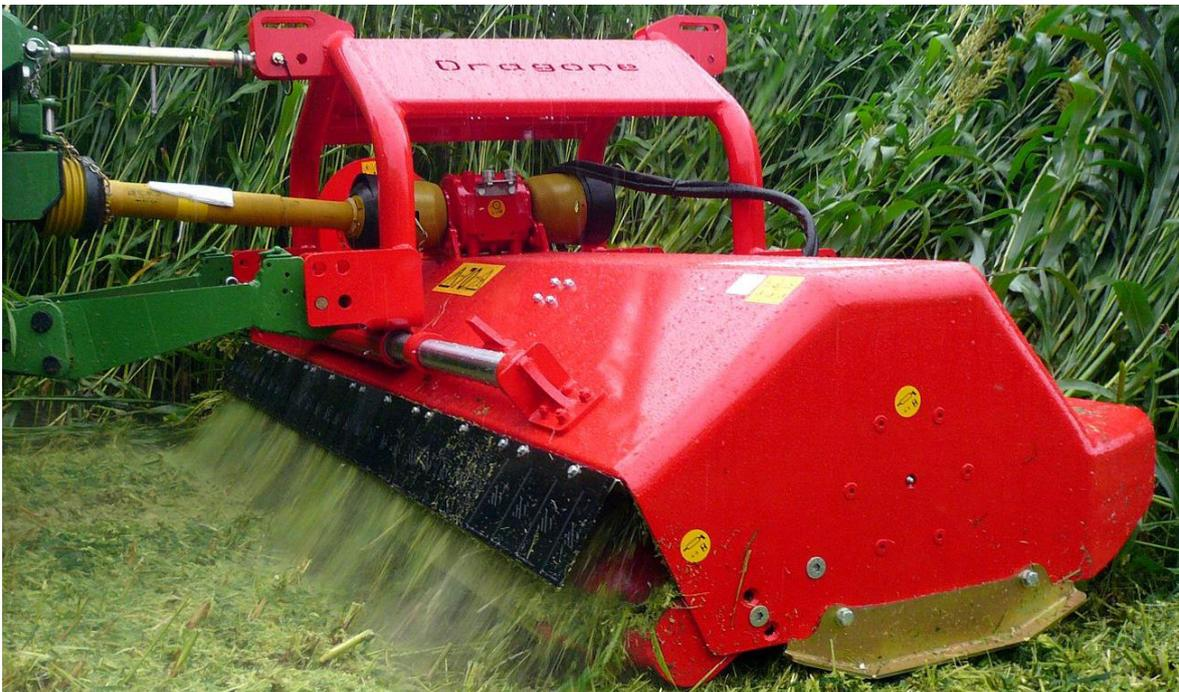
Abbildung 9: Mulchvorgang mit einem Schlegelmulcher (Vogt GmbH, 2015).
