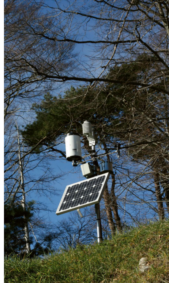
Station Sagno, TI: Meteostation mit Solarpanel, Regenwippe (grosser weisser Topf), Windgeschwindigkeitsmesser, Temperatur- und Luftfeuchte-Messeinheit (Objekt mit den weissen Lamellen) und auf der Spitze Lichtmesser (nicht zu sehen auf dem Bild)
