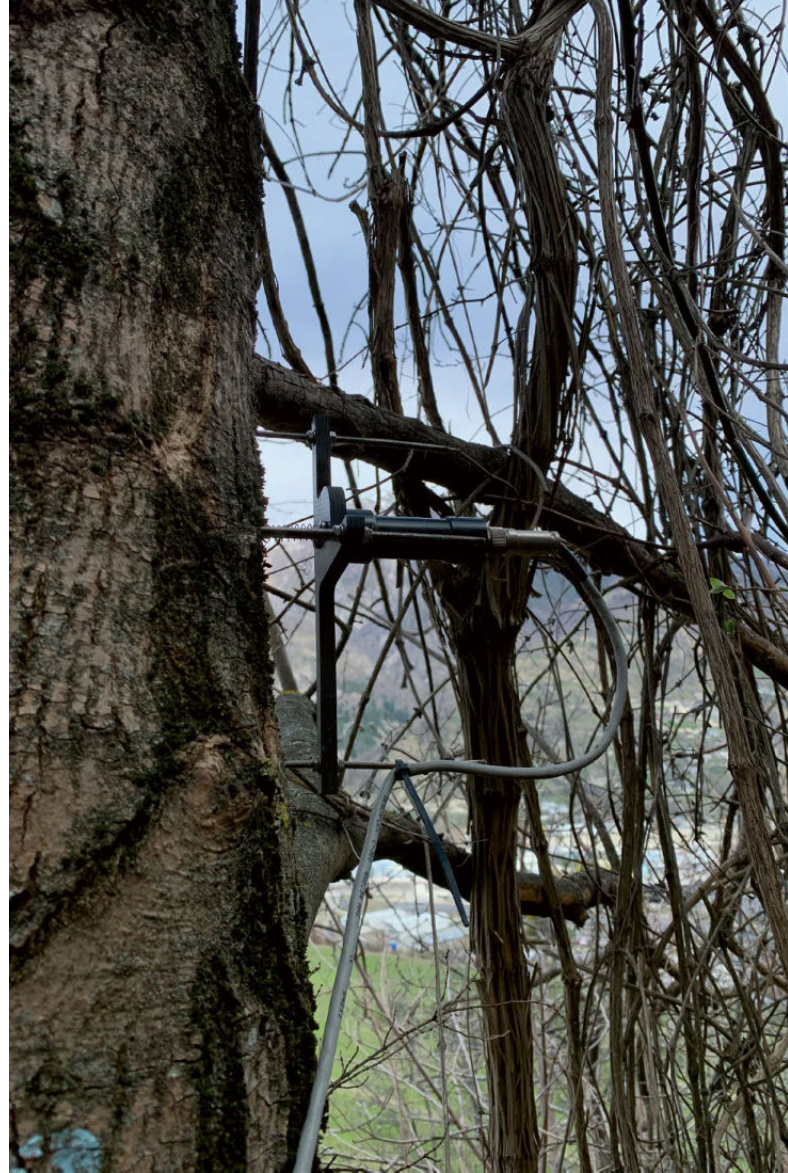
Punktendrometer an einem Eschenstamm Ende März in Visp, VS
